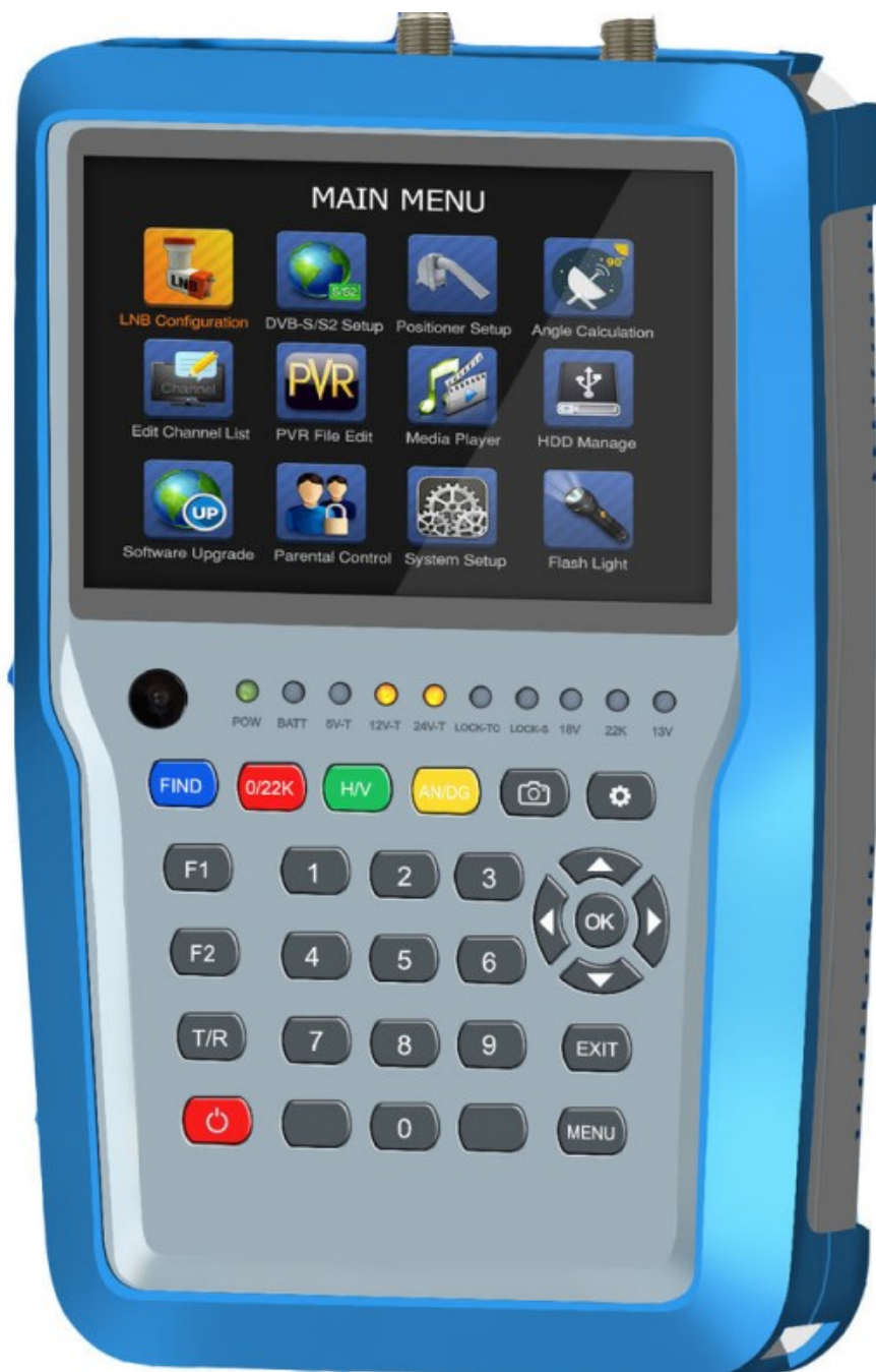
Miernik sygnału firmy Satlink model HW7380 COMBO UHD H.265/HEVC z wbudowanym zasilaniem. Umożliwia pomiar sygnału satelitarnego, naziemnego i kablowego.
